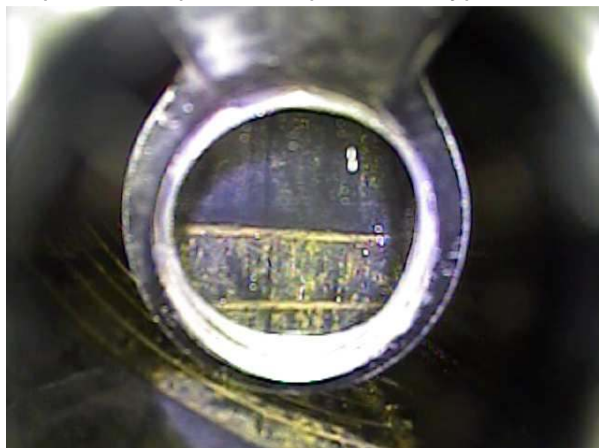
foto 17: Žlutý jemnozrný písek z pískového polštáře v perforaci, pokles obsypu 6 m.
